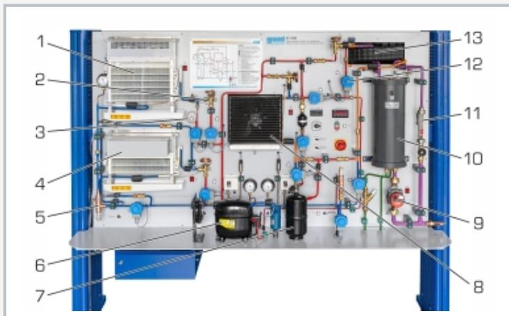
1 evaporador, 2 válvula de expansión, 3 tubo capilar, 4 evaporador (congelación), 5 regulador de la presión de evaporación, 6 compresor, 7 recipiente, 8 cambiador de calor con soplante, 9 bomba, 10 depósito para la mezcla de agua-glicol, 11 caudalímetro, 12 válvula electromagnética, 13 cambiador de calor de espiralado coaxial
