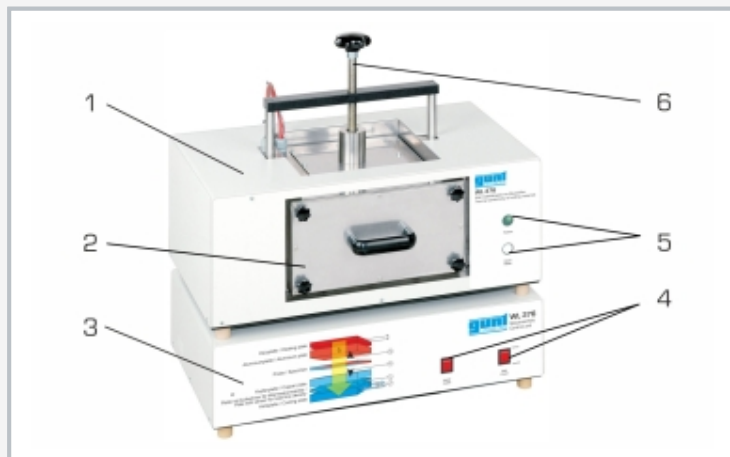
1 carcasa aislante, 2 tapa para cámara de muestras, 3 equipo de mando, 4 interruptor principal e interruptor de calefacción, 5 lámparas testigo, 6 husillo de presión
